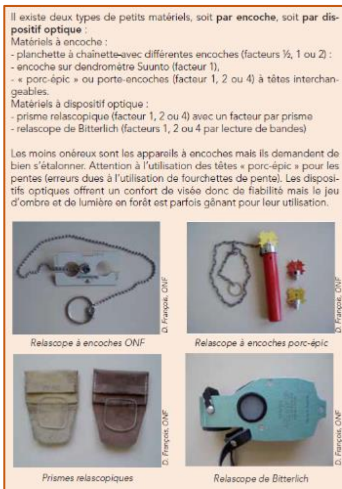
Encadré 1 : Appareils de mesure de la surface terrière pour placettes à angle fixe (extrait de Cordonnier et al. , 2007)
